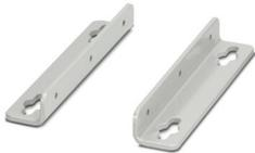
Adaptateur mural universel en 2 parties, pour le montage fixe de l'appareil, en cas de vibrations importantes. Les profilés vissés latéralement avec l'appareil doivent être vissés directement sur la surface de montage. La fixation de l'adaptateur mural universel se fait à droite/à gauche.
