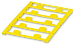
Etiquette en plastique, Planche, jaune, vierge, repérable avec : BLUEMARK ID COLOR, BLUEMARK ID, BLUEMARK CLED, PLOTMARK, CMS-P1-PLOTTER, type de montage: collage, surface utile: 11 x 9 mm, Nombre d'étiquettes: 10
