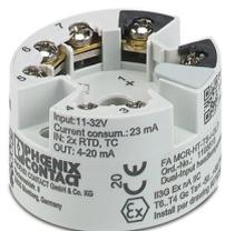
Transmetteur de tête alimenté par la boucle de sortie pour la transmission de jusqu'à 2 signaux de capteurs RTD et TC ainsi que de codeurs de résistance et de tension par 4 mA ... 20 mA. HART, Configuration standard, Safety Integrity Level (SIL, IEC 61508): 2, Systematic Capability: 3, Raccordement vissé
