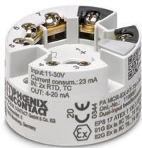
Ex i-Transmetteur de tête alimenté par la boucle de sortie pour la transmission de jusqu'à 2 signaux de capteurs RTD et TC ainsi que de codeurs de résistance et de tension par 4 mA ... 20 mA. HART, Configuration standard, Safety Integrity Level (SIL, IEC 61508): 2, Systematic Capability: 3, Raccordement vissé
