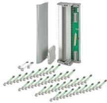
Termination Carrier pour la connexion redondante de 32 amplificateurs-séparateurs MACX Analog, à sécurité intrinsèque, aux cartes d'entrée TOR de l'automate HIMA-HIMax, par un connecteur C96, 96 pôles. Compatible avec la carte HIMax X-DI 32 01
