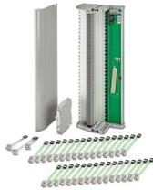
Termination Carrier pour la connexion redondante de 32 amplificateurs-séparateurs MACX Analog, à sécurité intrinsèque, aux cartes d'entrée TOR de l'automate HIMA-HIMax, par un connecteur C96, 96 pôles. Compatible avec la carte HIMax X-DI 32 02
