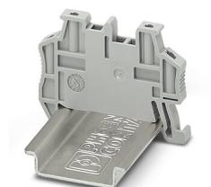
Crampon terminal à montage rapide, pour profilé NS 35/7,5 ou NS 35/15, avec possibilité de repérage, possibilité de montage pour FBS...5, FBS...6, KSS 5, KSS 6, largeur : 5,15 mm, coloris : gris
