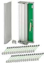
Termination Carrier pour la connexion de 32 blocs de commande de vanne MACX Analog à sécurité intrinsèque, aux cartes de sortie TOR de l'automate HIMA-HIMax, par un connecteur C96, 96 pôles. Compatible avec la carte HIMax X-DO 32 01, sans alimentation redondante
