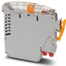
Module porte-fusible pour éléments de base VIP I/O-Marshalling avec fusible de 0,25 A remplaçable dans le circuit d'alimentation des appareillages de terrain. Des points de test intégrés et un couteau de sectionnement permettent la mesure sans interruption des signaux.
