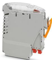
Module à relais pour éléments de base VIP I/O-Marshalling. Pour la commutation des charges de 230 V AC jusqu'à max. 3 A. Fusible intégré avec indicateur de défaillance. Contact NO utilisable.
