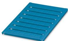
Repères pour blocs de jonction, Planche, bleu, vierge, repérable avec : BLUEMARK ID COLOR, BLUEMARK ID, BLUEMARK CLED, PLOTMARK, CMS-P1-PLOTTER, type de montage: encliquetage, pour bloc de jonction au pas de : 10,2 mm, surface utile: 9,6 x 10,5 mm, Nombre d'étiquettes: 48
