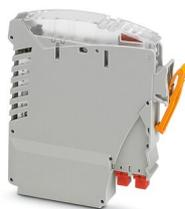
Module à relais pour éléments de base VIP I/O-Marshalling. Pour la commutation des charges de 230 V AC jusqu'à max. 3 A. Fusible intégré avec indicateur de défaillance. Contact NF utilisable.
