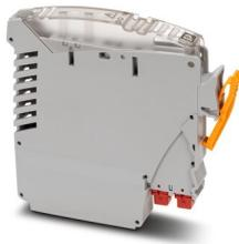
Dispositif de protection séparatif Ex-ic, non incendiaire, pour éléments de base VIP I/O-Marshalling. Pour la limitation du courant (60 mA ou 80 mA) et la tension (26,4 V DC) sur les sorties TOR. Par exemple pour le pilotage des électrovannes dans la zone ATEX (zone 2, CID2).
