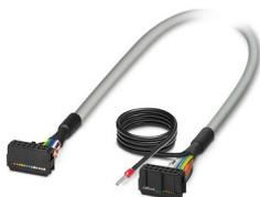
Câble rond blindé préconfectionné; raccordement 1 : IDC/FLK connecteur femelle (1x 14-pôles); raccordement 2 : IDC/FLK connecteur femelle (1x 14-pôles) (La tresse de blindage sort d'une extrémité de câble distincte.); longueur de câble: 2 m
