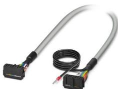
Câble rond blindé préconfectionné; raccordement 1 : IDC/FLK connecteur femelle (1x 14-pôles); raccordement 2 : IDC/FLK connecteur femelle (1x 14-pôles) (La tresse de blindage sort d'une extrémité de câble distincte.); longueur de câble: 3 m
