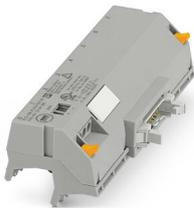
Adaptateur V8 pour 8 x PLC-INTERFACE (14 mm), automate: Câblage système API des cartes de sortie, raccordement 1: IDC/FLK connecteur mâle 1x 14-pôles, raccordement 2: Raccord enfichable (Encliquetable sur les 8x blocs de jonction PLC-INTERFACE), raccordement 3: Raccordement vissé 1x 2-pôles, nombre de canaux: 8, logique de commande: minusschaltend
