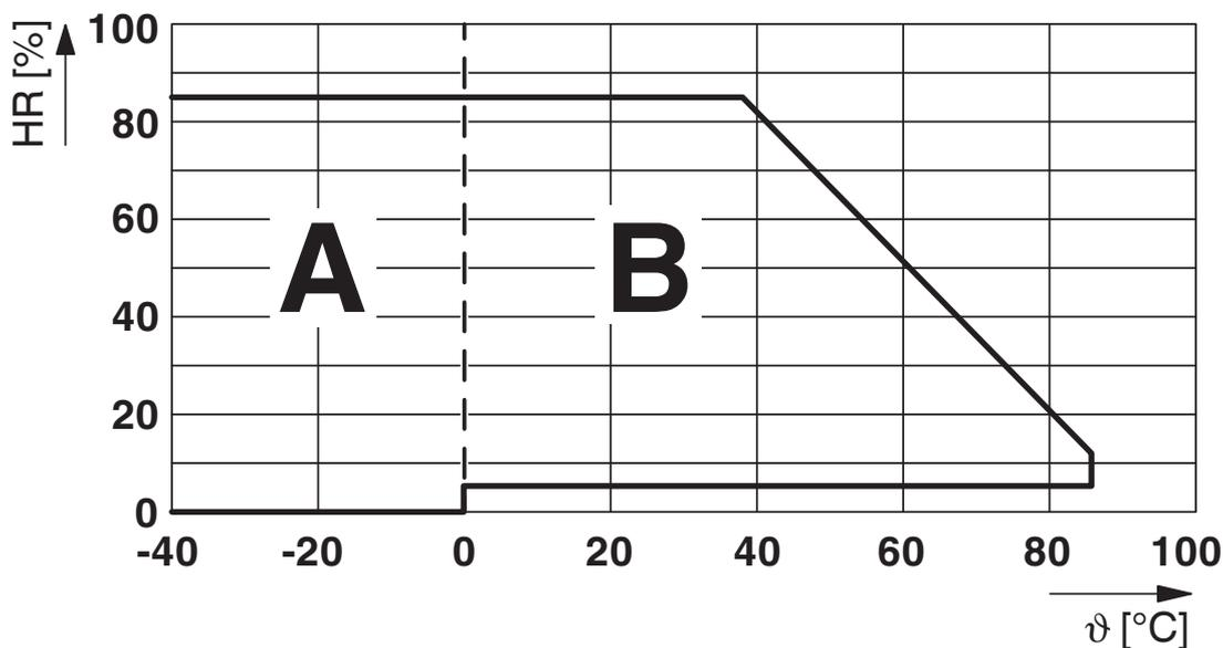
Humidité de l'air admise pour le fonctionnement et le stockage.
