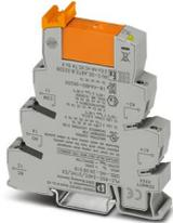
PLC-INTERFACE, composé d'un module de base de 14 mm à raccordement vissé pour montage sur profilé et d'un relais enfichable à contact de puissance 10 A, 1 contact inverseur, tension d'entrée 24 V DC. Homologué selon ATEX/IECEX (zone 2) et zone Ex classe I, div. 2.
