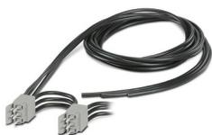
Ponts à boucles triphasés pour 4 modules de la gamme CONTACTRON, avec raccordement Push-in, largeur de boîtier : 22,5 mm, câble de raccordement : 1 m
