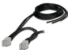
Pont à boucles triphasé pour 4 modules de la gamme CONTACTRON avec raccordement Push-in et boîtier de 22,5 mm de large, longueur de câble entre les modules : 0,3 m, câble de raccordement : 2 m
