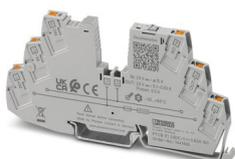
Protection électronique d'appareil mono-canal, pour récepteurs 12 - 24 V DC. Intensité nominale réglable de 0,1 à 0,63 A. Avec signalisation à distance et limitation active du courant. Combinable en des blocs de jonction CLIPLINE. Pour l'installation sur des rails DIN.
