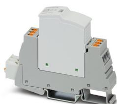
Parafoudre basse tension de type 3 composé d'une fiche de protection et d'un élément de base pour indicateur d'état intégré et signalisation à distance pour les réseaux d'alimentation monophasés. Tension nominale : 24 V AC/DC
