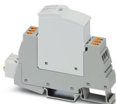
Parafoudre basse tension de type 2/3, avec fiche de protection et élément de base à raccordement Push-in. Pour réseaux électriques monophasés, avec indicateur d'état intégré et signalisation à distance. Tension nominale : 230 V AC/DC
