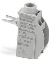
Bloc de jonction de dérivation, utilisable uniquement en combinaison avec la série VAL-Safe Energy Control-T2, Tension nominale : 400 V, Intensité nominale : 63 A, Type de raccordement : raccordement vissé, Section nominale : 25 mm<sup>2</sup>, Section : 1,5 mm<sup>2</sup> - 25 mm<sup>2</sup>, Coloris : gris
