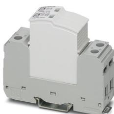
Parafoudre enfichable exempt de courant de fuite, suivant type 2 / Classe II, pour réseaux diphasés avec N et PE séparés (système à 3 fils : L1, N, PE), avec contact de signalisation à distance.
