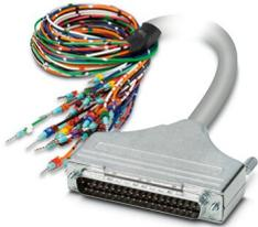
Câble rond blindé préconfectionné; raccordement 1 : Fils individuels (37-pôles) (Les fils sont repérés et équipés d'embouts); raccordement 2 : Connecteur mâle D-SUB (1x 37-pôles); longueur de câble: 10 m
