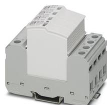
Parafoudre enfichable, suivant type 2/classe II, pour réseaux électriques triphasés avec N et T séparés (système à 5 fils : L1, L2, L3, N, T), avec contact de télésignalisation. Avec pouvoir de décharge de 40 kA, suivant les exigences de la norme VDE 0100-534:2016-10 concernant les parafoudres, au point d'alimentation de l'installation.
