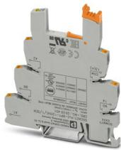
Module de base PLC de 6,2 mm pour fonctions d'entrée, avec raccordement Push-in, sans relais ni relais à semi-conducteurs, pour montage sur profilé NS 35/7,5, avec répartition de la tension d'alimentation de capteur (BB), 1 contact NO, tension d'entrée : 120 V AC/DC
