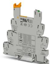
Module de base PLC de 6,2 mm pour courants permanents élevés avec raccordement vissé, sans relais ni relais à semi-conducteurs, pour montage sur profilé NS 35/7,5, 1 contact inverseur, tension d'entrée 120 V AC/DC
