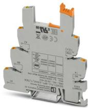
Module de base PLC de 6,2 mm pour fonctions d'entrée, avec raccordement Push-in, sans relais ni relais à semi-conducteurs, pour montage sur profilé NS 35/7,5, avec répartition de la tension d'alimentation de capteur (BB), 1 contact NO, tension d'entrée : 230 V AC/DC
