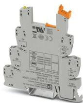
Module de base PLC de 6,2 mm pour fonctions d'entrée, à raccordement vissé, sans relais ni équipement relais à semi-conducteur, pour montage sur profilé NS 35/7,5, avec répartition de la tension d'alimentation de capteur (BB), 1 contact NO, tension d'entrée 230 V AC/DC
