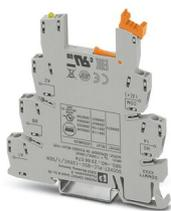
Module de base PLC de 6,2 mm pour fonctions d'entrée, avec raccordement vissé, sans relais ni relais à semi-conducteurs, pour montage sur profilé NS 35/7,5, avec répartition de la tension d'alimentation de capteur (BB), 1 contact NO, tension d'entrée : 120 V AC/DC
