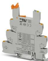
Module de base PLC de 6,2 mm avec raccordement Push-in, sans relais ni relais à semi-conducteurs, pour montage sur profilé NS 35/7,5, 1 contact inverseur, tension d'entrée : 120 V AC/DC
