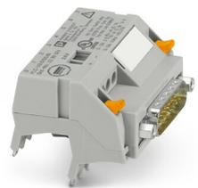
Adaptateur V8 pour 8 x PLC-INTERFACE (6,2 mm), automate: Câblage système API des cartes d'entrée, raccordement 1: Connecteur mâle D-SUB 1x 15-pôles, raccordement 2: Raccord enfichable (Encliquetable sur les 8x blocs de jonction PLC-INTERFACE), raccordement 3: Raccordement vissé 1x 2-pôles, nombre de canaux: 8, logique de commande: plusschaltend
