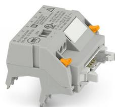
Adaptateur V8 pour 8 x PLC-INTERFACE (6,2 mm), automate: Câblage système API des cartes d'entrée, raccordement 1: IDC/FLK connecteur mâle 1x 14-pôles, raccordement 2: Raccord enfichable (Encliquetable sur les 8x blocs de jonction PLC-INTERFACE), raccordement 3: Raccordement vissé 1x 2-pôles, nombre de canaux: 8, logique de commande: plusschaltend
