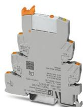
PLC-INTERFACE, composé d'un module de base PLC-BPT.../21 à raccordement Push-in et d'un relais miniature enfichable à contact doré multicouches et actionnement manuel, 1 contact inverseur, tension d'entrée 24 V DC
