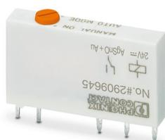
Relais de puissance miniature enfichable à contact doré multicouches, 1 contact inverseur, actionnement manuel, tension d'entrée 24 V DC
