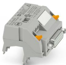
Adaptateur V8 pour 8 x PLC-INTERFACE (6,2 mm), automate: Câblage système API des cartes d'entrée, raccordement 1: Connecteur femelle D-SUB 1x 15-pôles, raccordement 2: Raccord enfichable (Encliquetable sur les 8x blocs de jonction PLC-INTERFACE), raccordement 3: Raccordement vissé 1x 2-pôles, nombre de canaux: 8, logique de commande: plusschaltend
