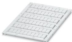
Repères pour blocs de jonction, Planche, blanc, vierge, repérable avec : TOPMARK NEO, LASER TOPMARK, BLUEMARK ID COLOR, BLUEMARK ID, BLUEMARK CLED, THERMOMARK PRIME, THERMOMARK CARD 2.0, THERMOMARK CARD, type de montage: encliquetage, pour bloc de jonction au pas de : 6,2 mm, surface utile: 5,6 x 10,5 mm, Nombre d'étiquettes: 60
