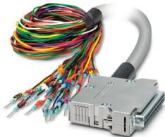
Câble rond blindé préconfectionné; raccordement 1 : Paire torsadée (37-pôles) (Les fils sont repérés et équipés d'embouts); raccordement 2 : Connecteur femelle D-SUB (1x 37-pôles); longueur de câble: 15 m
