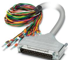
Câble rond blindé préconfectionné; raccordement 1 : Paire torsadée (37-pôles) (Les fils sont repérés et équipés d'embouts); raccordement 2 : Connecteur mâle D-SUB (1x 37-pôles); longueur de câble: 5 m
