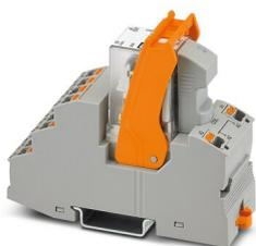
Module à relais prééquipé comprenant : embase de relais, module enfichable fonctionnel, relais à contacts de puissance et étrier de fixation, homologué selon ATEX/IECEX (zone 2) et Ex-Zone Class I, Div. 2, Raccordement Push-in, 4 contacts inverseurs, Varistance, Tension d'entrée: 230 V AC
