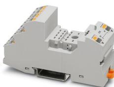
Embase de relais RIF-2.../EX à équiper de relais industriels étanches RTIII à 4 contacts inverseurs pour l'utilisation en zone 2, raccordement Push-in, enfichabilité pour modules d'entrée/antiparasite, montage sur NS 35/7,5
