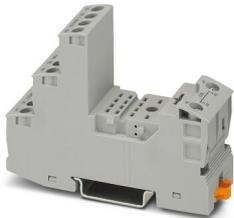
Embase de relais RIF-2.../EX à équiper de relais industriels étanches RTIII à 4 contacts inverseurs pour l'utilisation en zone 2, raccordement vissé, enfichabilité pour modules d'entrée/antiparasite, montage sur NS 35/7,5
