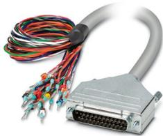
Câble rond blindé préconfectionné; raccordement 1 : Fils individuels (25-pôles) (Les fils sont repérés et équipés d'embouts); raccordement 2 : Connecteur mâle D-SUB (1x 25-pôles); longueur de câble: 3 m
