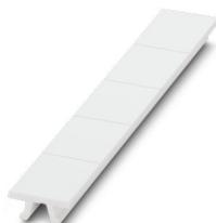
Ruban de repérage ZB, Rubans, blanc, vierge, repérable avec : PLOTMARK, CMS-P1-PLOTTER, type de montage: encliquetage, pour bloc de jonction au pas de : 15,2 mm, surface utile: 10,5 x 15,1 mm, Nombre d'étiquettes: 5
