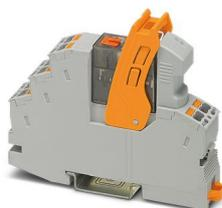
Module à relais prééquipé avec raccordement push-In, comprenant : embase de relais, étrier de fixation du relais, module antiparasite enfichable et relais à contacts de puissance avec touche de contrôle et LED de statut intégrée. Type de contact : 1 contact inverseur. Tension d'entrée : 120 V AC
