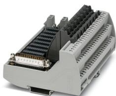
Élément de base VIP I/O-Marshalling à 8 canaux pour une utilisation universelle. Tous les raccordements sont vissés. Grâce au connecteur D-SUB 25, ce module est compatible avec les broches du système de contrôle de la série Foxboro I/A.
