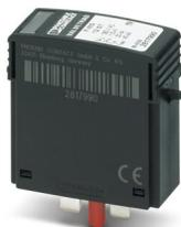
Parafoudre type 1, UL Recognized, et fiche parafoudre CEI type 2, avec éclateur à gaz et dispositif de déconnexion thermique, pour utilisation avec des éléments de base VAL-US, signalisation de défauts mécaniques et optiques
