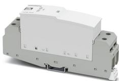
Parafoudre enfichable, selon type 1/classe I, avec fusible intégré résistant aux courants de choc, pour réseaux électriques monophasés avec PE et N combinés dans un conducteur (L1, PEN).
