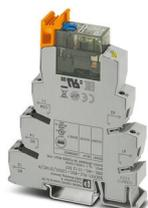
PLC-INTERFACE comprenant une embase de relais et un relais à contacts de puissance avec actionnement manuel et LED de statut intégrée, Raccordement vissé, 1 contact inverseur, Pont redresseur, Tension d'entrée: 120 V AC / 110 V DC
