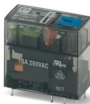
Relais miniature enfichable, avec contact de puissance, 1 contact inverseur, touche de test, affichage mécanique de position, voyant d'état, diode de roue libre, polarité A1+, A2-, tension d'entrée 110 V DC
