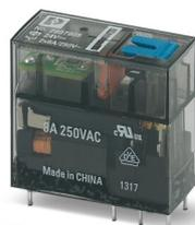
Relais miniature enfichable, avec contact multicouche plaqué or, 2 contacts inverseurs, touche de test, affichage mécanique de position, voyant d'état, diode de roue libre, polarité A1+, A2-, tension d'entrée 24 V DC
