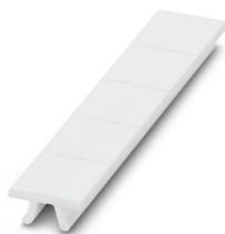
Ruban de repérage ZB, à commander : par bandes, blanc, impression selon les indications du client, type de montage: encliquetage dans la rainure de repérage élevée, pour bloc de jonction au pas de : 12,2 mm, surface utile: 10,5 x 12,15 mm, Nombre d'étiquettes: 5
