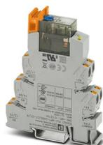
PLC-INTERFACE comprenant une embase de relais et un relais de contact doré multicouche avec actionnement manuel et LED de statut et diode de roue libre intégrées, Raccordement Push-in, 2 inverseurs, Diode de roue libre, Tension d'entrée: 24 V DC
