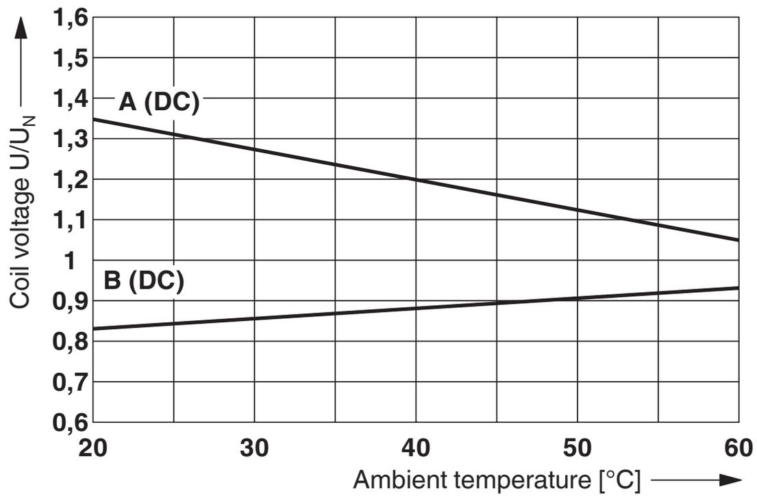
Courbe A : Tension permanente max. avec intensité permanente limite
