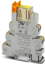
PLC-INTERFACE comprenant une embase de relais et un relais de sécurité enfichable avec contacts forcés selon DIN EN 61810-3, Raccordement Push-in, 2x contact inverseur à guidage forcé, Diode de roue libre, Tension d'entrée: 24 V DC
