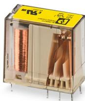
Relais de sécurité avec contacts à guidage forcé selon DIN EN 61810-3, type de commutation du contact 2 contacts inverseurs. Les exigences pour le type A selon DIN EN 61810-3 sont respectées lorsque le câblage est effectué avec 1 contact NO/1 contact NF.
