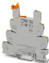
Module de base PLC de 6,2 mm pour applications ferroviaires avec raccordement Push-in, sans relais ni relais à semi-conducteurs, plage de 0,7 x  $U_N$  à 1,25 x  $U_N$ , plage de température de -25 °C à +70 °C, 1 contact inverseur, tension d'entrée 24 V DC
