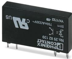
Relais à semi-conducteurs miniature enfichable, relais de puissance à semi-conducteurs, 1 contact NO, entrée : 5 V CC, sortie : 24-253 V CA/0,75 A
