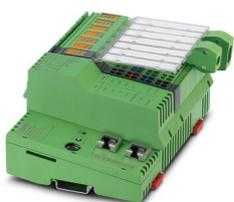
Contrôleur Inline avec interface PWM impulsion/direction, interface RS-485/422, compteurs rapides et entrées de codeur incrémental, possibilité de programmation selon IEC 61131-3
