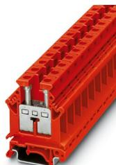
Blocs de jonction simple, tension nominale: 800 V, intensité nominale: 76 A, nombre de connexions: 2, type de raccordement: Raccordement vissé, Section de référence: 16 mm<sup>2</sup>, section : 2,5 mm<sup>2</sup> - 25 mm<sup>2</sup>, type de montage: NS 35/7,5, NS 35/15, NS 32, coloris: rouge
