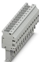
Connecteurs, tension nominale: 800 V, intensité nominale: 32 A, nombre de pôles: 13, type de raccordement: Raccordement vissé, Section de référence: 4 mm<sup>2</sup>, section : 0,2 mm<sup>2</sup>- 6 mm<sup>2</sup>, coloris: gris
