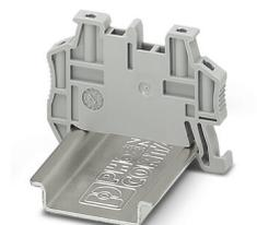
Crampon terminal à montage rapide, pour profilé NS 35/7,5 ou NS 35/15, avec possibilité de repérage, possibilité de montage pour FBS...5, FBS...6, KSS 5, KSS 6, largeur : 5,15 mm, coloris : gris
