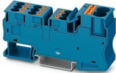
Borne collectrices de potentiel, tension nominale: 1000 V, intensité nominale: 57 A, nombre de connexions: 11, type de raccordement: Raccordement Push-in, Raccordement collectif, Section de référence: 10 mm<sup>2</sup>, section : 0,5 mm<sup>2</sup> - 16 mm<sup>2</sup>, Raccordement Push-in, Dérivation, Section de référence: 4 mm<sup>2</sup>, section : 0,5 mm<sup>2</sup> - 6 mm<sup>2</sup>, type de montage: NS 35/7,5, coloris: bleu
