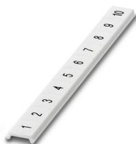
Ruban de repérage ZB, plat, Rubans, blanc, repéré, impression longitudinale: numérotation continue 1 ... 10, 11 ... 20, etc. jusqu'à 91 ... 100, type de montage: encliquetage, pour bloc de jonction au pas de : 6,2 mm, surface utile: 5,15 x 6,15 mm, Nombre d'étiquettes: 10
