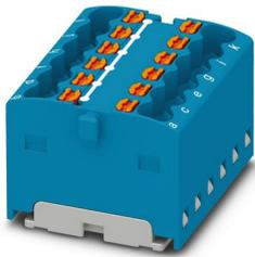
Bloc distributeur, pontage interne, tension nominale: 450 V, intensité nominale: 17,5 A, nombre de connexions: 12, type de raccordement: Raccordement Push-in, section : 0,14 mm<sup>2</sup> - 2,5 mm<sup>2</sup>, type de montage: collage, coloris: bleu
