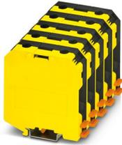
Bloc de jonction de puissance, avec vis à six pans creux, tension nominale: 1000 V, intensité nominale: 150 A, nombre de connexions: 2, nombre de pôles: 1, type de raccordement: Raccordement vissé, section : 16 mm<sup>2</sup> - 70 mm<sup>2</sup>, type de montage: NS 35/7,5, NS 35/15, NS 32, NS 35/15-2,3, coloris: noir/jaune
