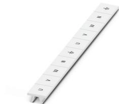
Repères pour blocs de jonction, Rubans, blanc, repéré, repérable avec : CMS-P1-PLOTTER, longitudinal: U, V, W, N, GND, U, V, W, N, GND, type de montage: encliquetage, pour bloc de jonction au pas de : 10,2 mm, surface utile: 10,15 x 10,5 mm, Nombre d'étiquettes: 10
