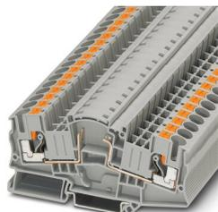
Composant du bloc de jonction, pour le montage de composants à choisir soi-même, tension nominale: 500 V, intensité nominale: 30 A, type de raccordement: Raccordement Push-in, 1er étage, Section de référence: 6 mm<sup>2</sup>, section : 0,5 mm<sup>2</sup> - 10 mm<sup>2</sup>, coloris: gris
