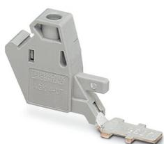
Bloc de jonction de dérivation, tension nominale: 1000 V, intensité nominale: 32 A, nombre de connexions: 1, type de raccordement: Raccordement vissé, section : 0,14 mm<sup>2</sup> - 6 mm<sup>2</sup>, type de montage: sur embase, coloris: gris
