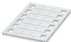
Repères pour blocs de jonction, à commander : sous forme de planche, blanc, impression selon les indications du client, type de montage: encliquetage dans la rainure de repérage élevée, pour bloc de jonction au pas de : 16 mm, surface utile: 14,8 x 9,6 mm, Nombre d'étiquettes: 18
