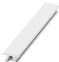
Ruban de repérage ZB, à commander : par bandes, blanc, impression selon les indications du client, type de montage: encliquetage dans la rainure de repérage élevée, pour bloc de jonction au pas de : 16 mm, surface utile: 10,5 x 16 mm, Nombre d'étiquettes: 5
