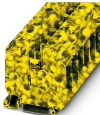
Blocs de jonction simple, tension nominale: 1000 V, intensité nominale: 125 A, nombre de connexions: 2, type de raccordement: Raccordement vissé, Section de référence: 35 mm<sup>2</sup>, section : 1,5 mm<sup>2</sup> - 50 mm<sup>2</sup>, type de montage: NS 35/7,5, NS 35/15, coloris: noir/jaune
