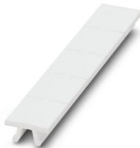
Ruban de repérage ZB, à commander : par bandes, blanc, impression selon les indications du client, type de montage: encliquetage dans la rainure de repérage élevée, pour bloc de jonction au pas de : 13 mm, surface utile: 13 x 10,5 mm, Nombre d'étiquettes: 5
