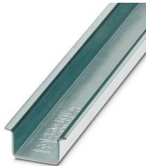
Profilé plein, similaire à EN 60715, matériau: Acier, galvanisé, passivation blanche, Profil standard, coloris: argenté, Conditionnement par 10 unités (20 m)
