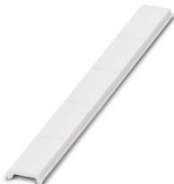
Ruban de repérage ZB, plat, à commander : par bandes, blanc, impression selon les indications du client, type de montage: encliquetage dans la rainure de repérage plate, pour bloc de jonction au pas de : 13 mm, surface utile: 13 x 5,2 mm, Nombre d'étiquettes: 5
