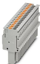
Connecteurs, tension nominale: 500 V, intensité nominale: 17,5 A, nombre de connexions: 16, nombre de pôles: 16, type de raccordement: Raccordement Push-in, 1er étage, Section de référence: 1,5 mm<sup>2</sup>, section : 0,14 mm<sup>2</sup> - 1,5 mm<sup>2</sup>, coloris: gris
