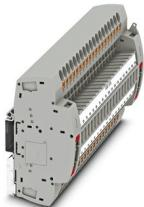
Connecteur de test, Détrompage de type H19 selon la norme allemande VDE, tension nominale: 400 V, nombre de connexions: 38, nombre de pôles: 19, type de raccordement: Raccordement Push-in, 1er étage, Section de référence: 6 mm<sup>2</sup>, section : 0,5 mm<sup>2</sup> - 10 mm<sup>2</sup>, type de montage: NS 35/7,5, NS 35/15, coloris: gris
