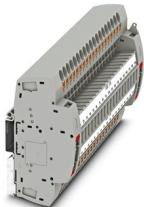
Connecteur de test, Détrompage de type I19 selon la norme allemande VDE, tension nominale: 400 V, nombre de connexions: 38, nombre de pôles: 19, type de raccordement: Raccordement Push-in, 1er étage, Section de référence: 6 mm<sup>2</sup>, section : 0,5 mm<sup>2</sup> - 10 mm<sup>2</sup>, type de montage: NS 35/7,5, NS 35/7,5, coloris: gris
