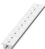
Ruban de repérage ZB, Rubans, blanc, repéré, repérable avec : CMS-P1-PLOTTER, impression transversale: numérotation continue 1 ... 10, 11 ... 20, etc. jusqu'à 91 ... 100, type de montage: encliquetage, pour bloc de jonction au pas de : 8,2 mm, surface utile: 10,5 x 8,15 mm, Nombre d'étiquettes: 10
