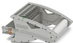
Connecteur d'essai, configurable, avec poignée tournante, tension nominale: 400 V, intensité nominale: 24 A, Section de référence: 2,5 mm<sup>2</sup>, coloris: gris
