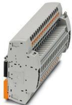
Connecteur de test, tension nominale: 400 V, nombre de connexions: 34, nombre de pôles: 17, type de raccordement: Raccordement Push-in, 1er étage, Section de référence: 6 mm<sup>2</sup>, section : 0,5 mm<sup>2</sup> - 10 mm<sup>2</sup>, type de montage: NS 35/7,5, NS 35/7,5, coloris: gris
