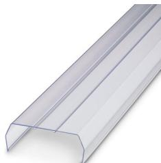
Profilé de protection, pour recouvrir les barrettes de raccordement, s'encliquette sur le capot de protection profilé APT-ME ou le crampon terminal APH-ME. Placer un capot de protection profilé aux extrémités de la barrette et à intervalles d'environ 40 cm. Longueur : 1 m
