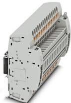
Connecteur de test, tension nominale: 400 V, nombre de connexions: 50, nombre de pôles: 25, type de raccordement: Raccordement Push-in, 1er étage, Section de référence: 6 mm<sup>2</sup>, section : 0,5 mm<sup>2</sup> - 10 mm<sup>2</sup>, type de montage: NS 35/7,5, NS 35/7,5, coloris: gris
