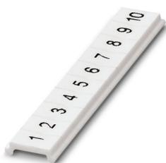
Ruban de repérage ZB, plat, Rubans, blanc, repéré, impression longitudinale: numérotation continue 1 ... 10, 11 ... 20, etc. jusqu'à 91 ... 100, type de montage: encliquetage, pour bloc de jonction au pas de : 3,5 mm, surface utile: 5,15 x 3,5 mm, Nombre d'étiquettes: 10
