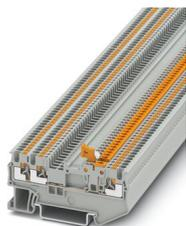
Bloc de jonction à couteau de sectionnement, tension nominale: 400 V, intensité nominale: 10 A, 1er étage, type de raccordement: Raccordement Push-in, Section de référence: 1,5 mm<sup>2</sup>, section : 0,14 mm<sup>2</sup> - 1,5 mm<sup>2</sup>, montage: NS 35/7,5, NS 35/15, coloris: gris
