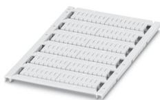
Repères pour blocs de jonction, à commander : sous forme de planche, blanc, impression selon les indications du client, type de montage: encliquetage dans la rainure de repérage élevée, pour bloc de jonction au pas de : 3,5 mm, surface utile: 2,95 x 10,5 mm, Nombre d'étiquettes: 102
