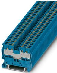
Blocs de jonction simple, tension nominale: 500 V, intensité nominale: 17,5 A, nombre de connexions: 4, type de raccordement: Raccordement Push-in, Section de référence: 2,5 mm<sup>2</sup>, section : 0,14 mm<sup>2</sup> - 4 mm<sup>2</sup>, type de montage: NS 35/7,5, NS 35/15, coloris: bleu
