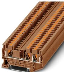
Blocs de jonction simple, tension nominale: 800 V, intensité nominale: 32 A, nombre de connexions: 3, type de raccordement: Raccordement Push-in, Section de référence: 4 mm<sup>2</sup>, section : 0,2 mm<sup>2</sup> - 6 mm<sup>2</sup>, type de montage: NS 35/7,5, NS 35/15, coloris: marron
