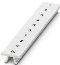
Ruban de repérage ZB, Rubans, blanc, repéré, repérable avec : CMS-P1-PLOTTER, impression transversale: numérotation continue 1 ... 10, 11 ... 20, etc. jusqu'à 491 ... 500, type de montage: encliquetage, pour bloc de jonction au pas de : 6,2 mm, surface utile: 6,15 x 10,5 mm, Nombre d'étiquettes: 10
