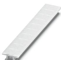
Repères pour blocs de jonction, Rubans, blanc, repéré, repérable avec : CMS-P1-PLOTTER, impression longitudinale: U, V, W, N, GND, U, V, W, N, GND, type de montage: encliquetage, pour bloc de jonction au pas de : 6,2 mm, surface utile: 6,15 x 10,5 mm, Nombre d'étiquettes: 10
