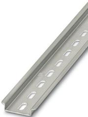
Profilé percé, selon EN 60715, matériau: Acier, galvanisé, traité par passivation couche épaisse, Profil standard, coloris: argent, Conditionnement par 25 unités (50 m)
