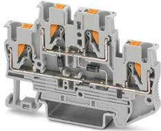
Composant du bloc de jonction, avec diode intégrée 1N4007, tension nominale: 500 V, intensité nominale: 0,5 A, nombre de connexions: 4, type de raccordement: Raccordement Push-in, Section de référence: 2,5 mm<sup>2</sup>, section : 0,14 mm<sup>2</sup> - 4 mm<sup>2</sup>, type de montage: NS 35/7,5, NS 35/15, coloris: gris
